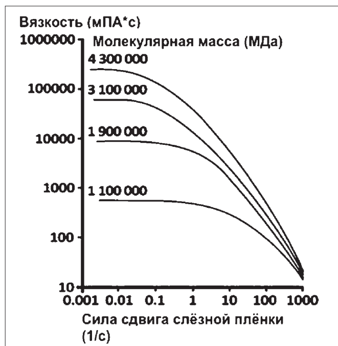
Рис. 2. Зависимость вязкости препарата 1 % гиалуроновой кислоты от скорости сдвига слезной пленки при различных массах молекул гиалуроната. Dependency of viscosity on the shear rate in 1 % HA solutions with different molecular weights [13].
