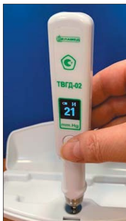
Рис. 2. Проверка работоспособности тонометра на контрольном устройстве Fig. 2. Checking the tonometer's operability on the control device
